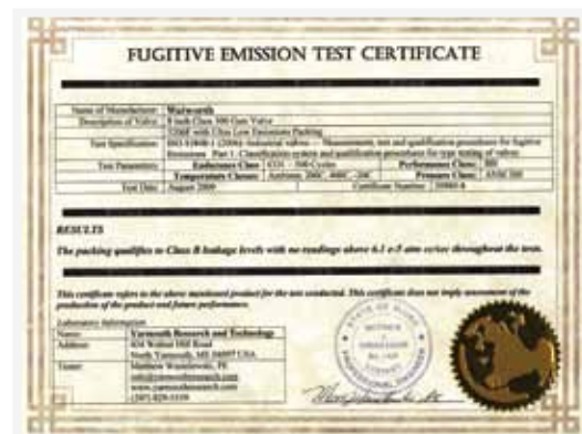
Certificado de Emisiones Fugitivas de 500 ciclos para válvulas de compuerta de 8" clase 300# Emitido por Yarmouth Research and Technology, que califican toda la gama de productos de Acero Fundido.
