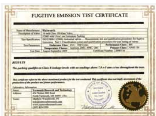
Certificado de Emisiones Fugitivas de 500 ciclos para válvulas de compuerta de 16" clase 150# Emitido por Yarmouth Research and Technology, que califican toda la gama de productos de Acero Fundido.
